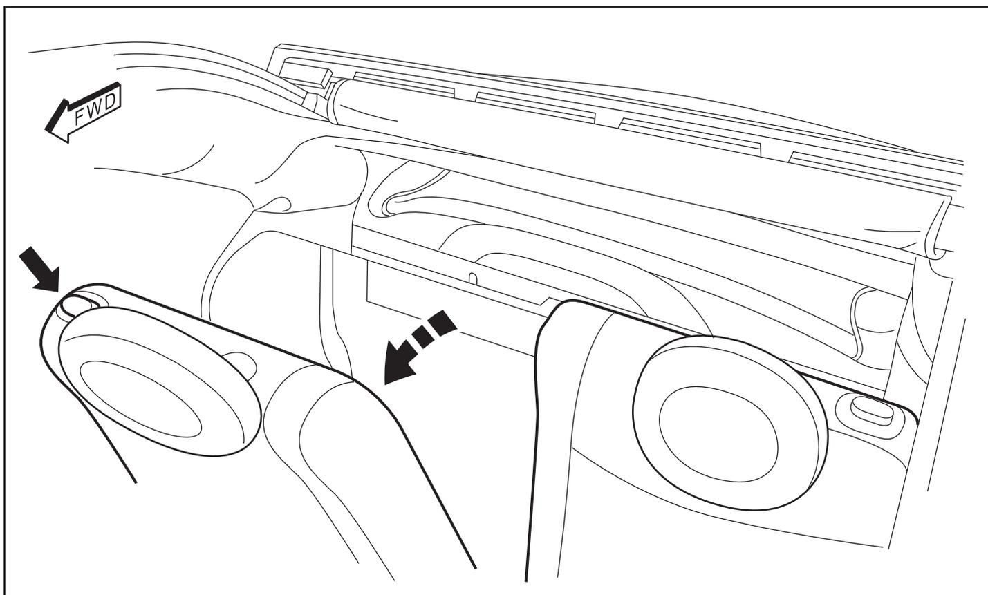
4. Abaisser l'écran pare-vent en position devant la tablette arrière. Insérer délicatement les supports de montage gauche et droit dans les fentes sous la tablette arrière.
