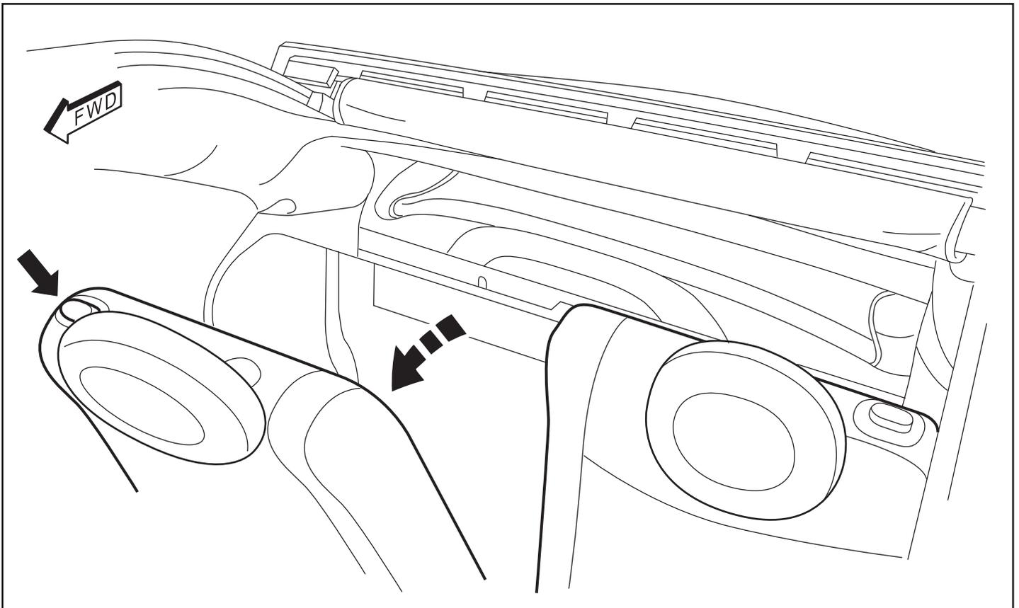
4. Baje la malla para colocarla al frente del tablero trasero. Inserte con cuidado los soportes de montaje izquierdo y derecho en la ranura ubicada debajo del tablero trasero.
